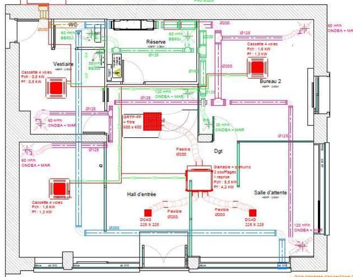
Grille d'entrée d'air neuf type GAB 25 = grille antivolant 300 x 300 installation de la grille dans le bandeau blanc. Clouage de la grille au RAL du bandeau blanc.
